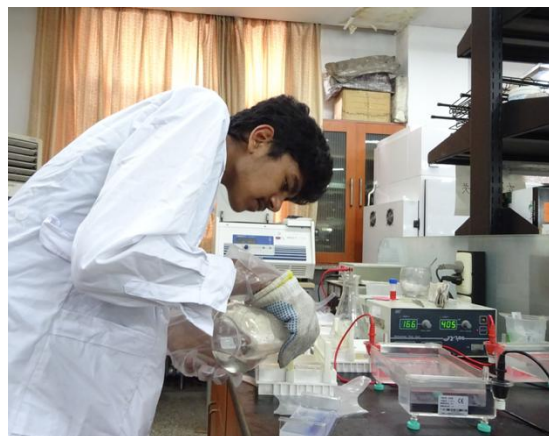
Pouring an Agarose Gel
